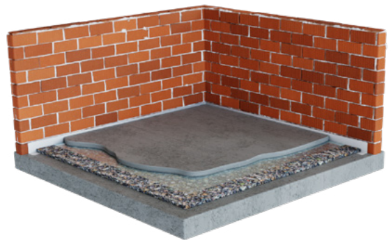
PASO 4: Aplicar pegamento sobre la cara vista de RECYPREN®.
